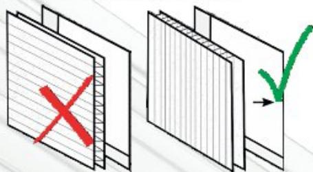
Desky instalujte s ochranou proti UV záření vždy z horní (vnější) strany. Označení je na ochranné fólii.
