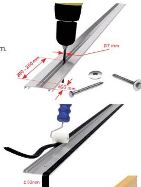
3. Natlačte gumové těsnění do obou drážek hliníkové přítlačné lišty a to s přesahem cca 50 mm na obou jejich koncích.
