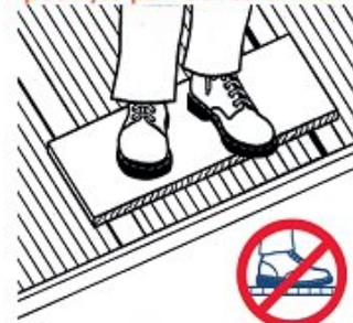
Desky upevňujte na okrajích do zasklívacích drážek nebo profilů minimálně do hloubky 20 mm.
